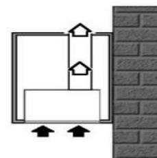
Вытяжку следует присоединить к отверстию отводящему воздух наружу при помощи жесткого или эластичного трубопровода диаметром 120 мм, который следует приобрести в специализированном магазине. Вытяжку должен подключать квалифицированный монтажник.
